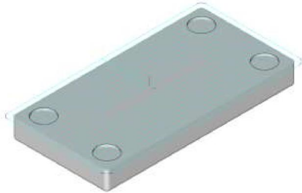
Das Rohteil wurde als Begrenzung des Materials auf die Teilegeometrie erstellt
